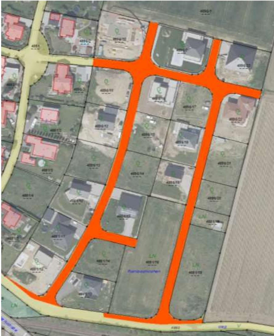
Die Arbeiten umfassen die Herstellung der Grob- und Feinplanie (ca. 3.500 m<sup>2</sup>), ca. 100m Leistensteine, ca. 15 Straßeneinläufe, Anpassen von 32 Kanalschächten und 16 Wasser-schiebern und Asphaltierung (ca. 3.000 m<sup>2</sup>).
