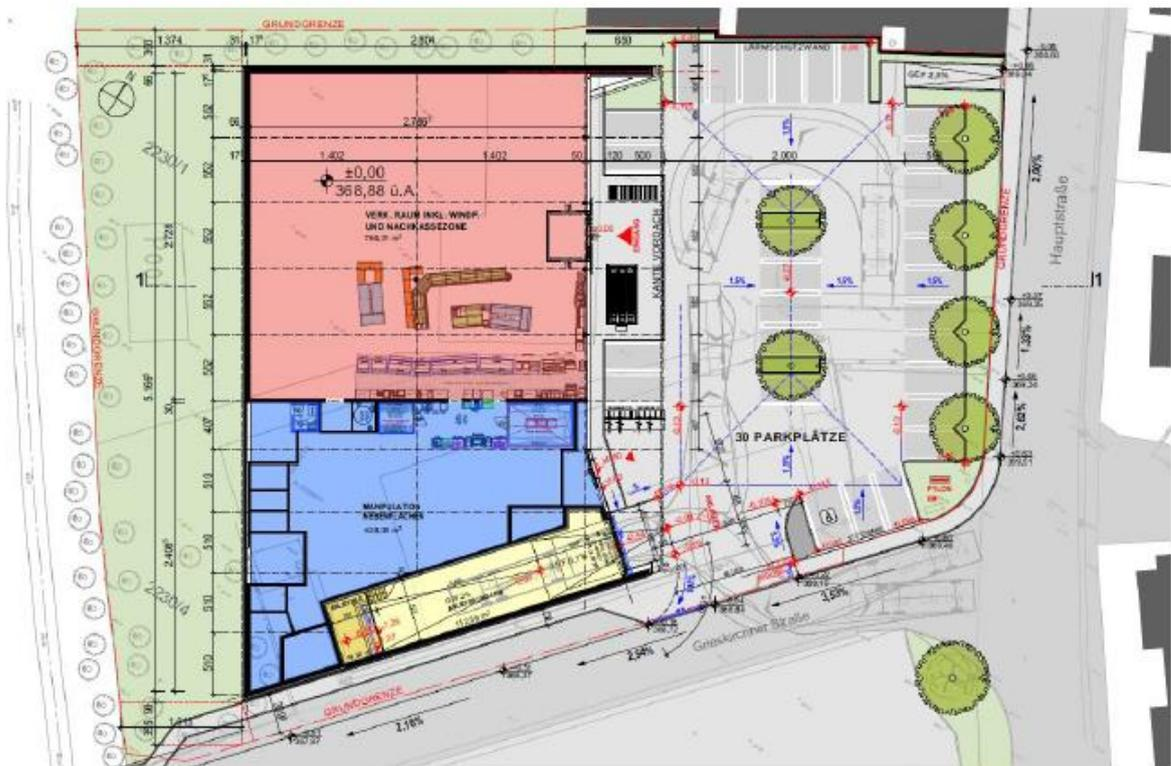
Abb. 8: Grundriss Erdgeschoß des geplanten Neubaus auf den beiden Liegenschaften. [Quelle: TEAM M Architekten Linz © 09.05.2023]
